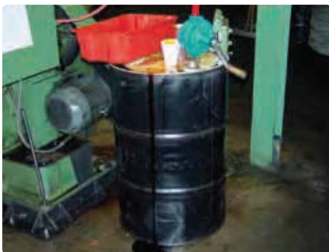
Vairs nekādu pilējumu no sūkņa, kas tek uz grīdu pa mucas sānu malu.
