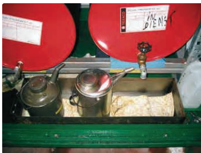
OP ( OIL PLUS ) paklāji novietoti zem kannām un mucām, lai uztvertu pilējumus.
