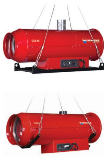
**EC/S e PHOEN/S:** in acciaio verniciato, alimentati a gasolio, con bruciatore integrato (EC) e separato (PHOEN) dal ventilatore, a combustione indiretta: impiegano uno scambiatore di calore che permette l'evacuazione dei fumi attraverso un camino collegabile con l'esterno; possono quindi essere collocati all'interno di locali chiusi, per contro hanno un costo più elevato ed un rendimento intorno al 90% dovendosi calcolare, in riduzione la quantità di calore evacuata attraverso il camino.
