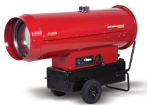
**EC e PHOEN:** alimentati a gasolio, con bruciatore integrato (EC) e separato (PHOEN) dal ventilatore, a combustione indiretta: impiegano uno scambiatore di calore che permette l'evacuazione dei fumi attraverso un cammino collegabile con l'esterno; possono quindi essere collocati all'interno di locali chiusi, per contro hanno un costo più elevato ed un rendimento intorno al 90%, dovendosi calcolare, in riduzione, la quantità di calore evacuata attraverso il cammino.
