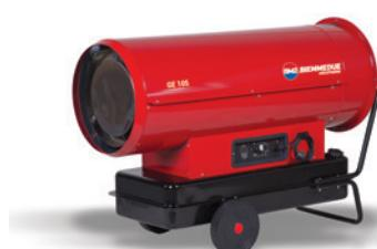
**GE:** alimentati a gasolio, con bruciatore integrato, a combustione diretta: i residui della combustione vengono espulsi con l'aria calda prodotta dal generatore e contribuiscono al suo riscaldamento, per questo motivo hanno un rendimento del 100% ovvero trasformano tutta la potenza bruciata in potenza termica resa. Sono i più economici, anche per quel che riguarda l'esercizio ma per contro possono essere impiegati solamente in locali areati.
