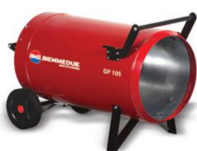
**GP:** alimentati a GPL in alta pressione (1,5 bar), con bruciatore integrato ed a combustione diretta. Sono realizzati in due versioni: ad accensione manuale (M) tramite piezoelettrico ed ad accensione automatica (A) grazie ad una apparecchiatura di controllo fiamma, che consente il collegamento di un termostato per controllare accensione e spegnimento. Per la loro alimentazione vengono in genere collegati alle bombole di GPL, il che li rende maneggevoli e molto economici.
