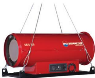
**GE/S:** in acciaio verniciato, alimentati a gasolio, con bruciatore integrato, a combustione diretta: i residui della combustione vengono espulsi con l'aria calda prodotta dal generatore e contribuiscono al suo riscaldamento, per questo motivo hanno un rendimento del 100% ovvero trasformano tutta la potenza bruciata in potenza termica resa. Sono i più economici, anche per quel che riguarda l'esercizio ma per contro possono essere impiegati solamente in locali areati.
