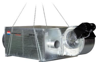
**FARM:** in acciaio zincato, a combustione indiretta, sono macchine di grande dimensione per ambienti più voluminosi. Possono montare indifferentemente un bruciatore esterno a gasolio, GPL o metano e possono essere equipaggiate con un ventilatore centrifugo che oltre ad essere più silenzioso garantisce maggiore prevalenza, caratteristica consigliabile in particolare per montaggi ove siano previste canalizzazioni o strutture di grande lunghezza.
