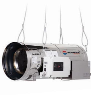
**GA/N:** in acciaio inox, alimentabili a GPL o metano in bassa pressione (20-30 mbar), con bruciatore integrato ed a combustione diretta. Possono essere facilmente pilotati da un'unità di controllo esterna. A differenza del modello GA, funzionando a bassa pressione, possono essere sempre installati internamente, indipendentemente dalla normativa di riferimento in vigore.
